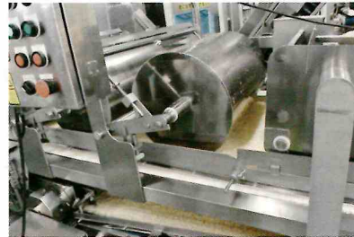
パン粉を付ける工程です。ローラーの絶妙な力加減でしっかりとつけています。
